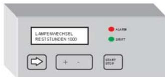
Rest - Betriebsdauer:300 Std., das Alarm LED blinkt, und alle halbe Stunde ertönt ein "Piepton"
